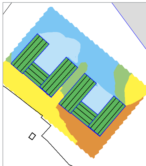
Figur 6: Beräknad dygnsekvivalent ljudnivå 1.5 m över mark för alternativ utformning av bostäderna.
