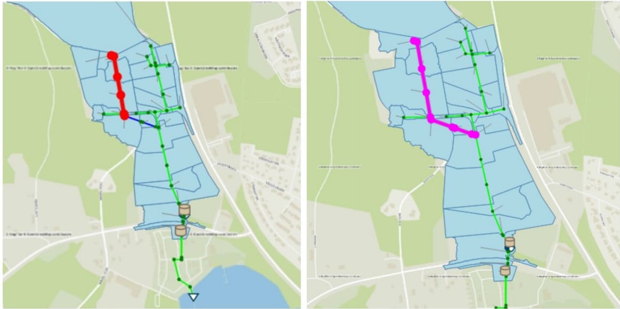
Figur 7. Urklipp från modellen i MIKE+. I rött redovisas aktuell ledningssträcka inom fastigheten samt utlopp till dike söderut. I rosa redovisas ledningssträcka som även inkluderar diket, trumma samt anslutande ledning till huvudstråket.
